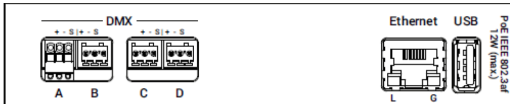
grandMA3 4Port Node DIN-Rail – Rückseite
